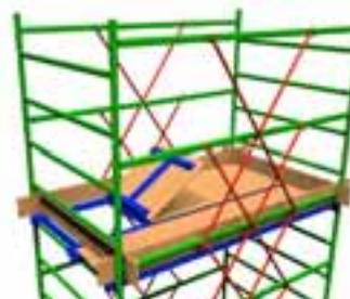
6. Рабочая платформа имеет ограждение, состоящее из двух боковин с расстоянием между перемычками 450 мм и двух поручней, связанных с нижними горизонтальными скрещивающимися стяжками.
