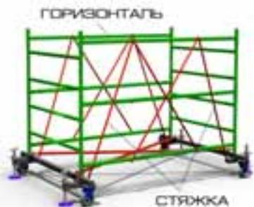
4. Установите в захваты нижних горизонталей скрещивающиеся стяжки и после установки верхних горизонталей вставьте верхние концы всех четырех стяжек с каждой стороны в соответствующие захваты
