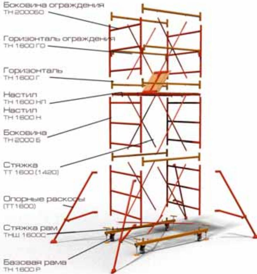
\*\* Ограждение настила и Дополнительные опоры предназначены для повышения устойчивости конструкции и более комфортной работы при большой высоте.
