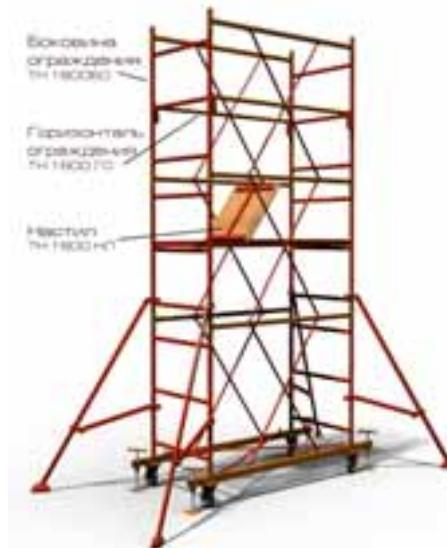
7. Переставляя настил по ступеням наращиваем высоту вышки-туры. Боковины ограждения отличаются от основных боковин наличием узла крепления горизонталей ограждения. Рабочая площадка туры имеет размер 800x1600 мм, состоит из одного настила. Площадка имеет входной люк.
