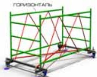
4. Установите в захваты нижних горизонталей скрещивающиеся стяжки и после установки верхних горизонталей вставьте верхние концы всех четырех стяжек с каждой стороны в соответствующие захваты
