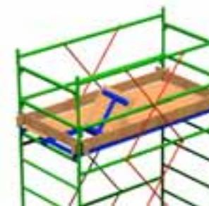
6. Рабочая платформа имеет ограждение, состоящее из двух боковин с расстоянием между перемычками 450 мм и двух поручней, связанных с нижними горизонтальными скрещивающимися стяжками.
