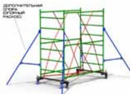
5. В такой последовательности (установка нижних горизонталей, установка боковин, установка верхних горизонталей и затем скрещивающихся стяжек) продолжайте монтаж помоста (туры). Если высота помоста превышает 4м, установите 4 дополнительные опоры.
