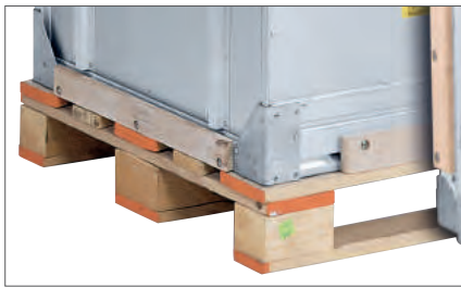
Rammschutzleisten aus Hartholz
