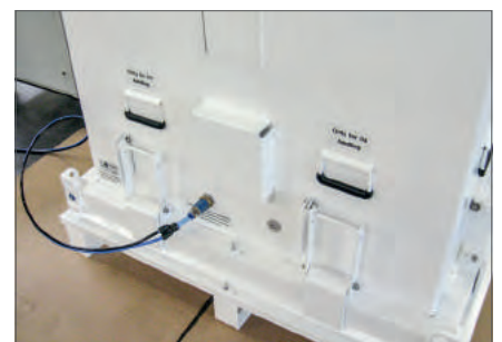
Wasserdampfdichter Behälter bei Dichtheitsprüfung durch Überdruck
