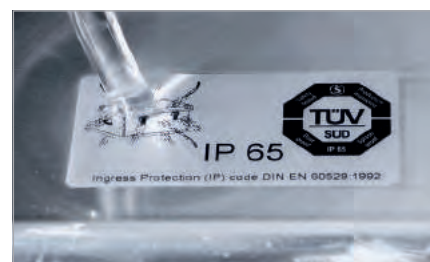
Strahlwasserschutz nach Norm IP 65
