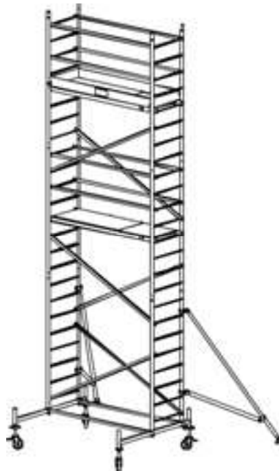
Арт. № 910158 рабоч. высота: 7,3 м высота подмостей: 6,3 м высота раб. площадки: 5,3 м
